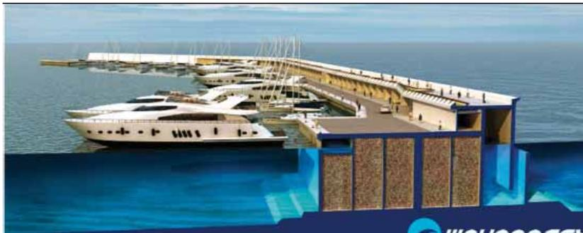
energetica nelle strutture portuali, proprio a fronte del loro impatto ambientale. Il progetto propone uno studio di fattibilità per adottare la tecnologia REWEC3 (REsonant Wave Energy Converter Realization 3/3) o U-OWC per la conversione di energia ondosa in energia elettrica, da integrare in dighe portuali sia preesistenti che di nuova realizzazione.
